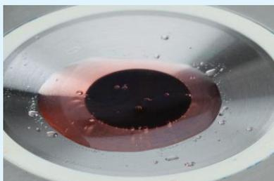
Многие реальные пробы могут содержать газовые пузырьки. Если пузырек располагается не на поверхности призмы, то такие образцы могут быть правильно проанализированы. Если же пузырьки оказываются на границе между призмой и пробой, то результат измерения окажется ошибочным.
